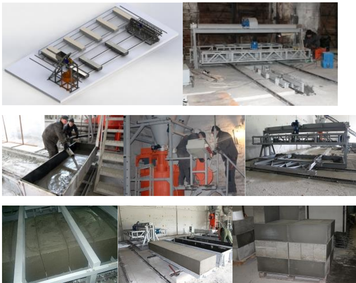
Рисунок 1 - Внешний вид линии для производства газобетона конвейерного типа
